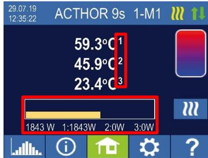
Bei Verwendung mehrerer Temperaturfühler wird die Fühlernummer eingeblendet
