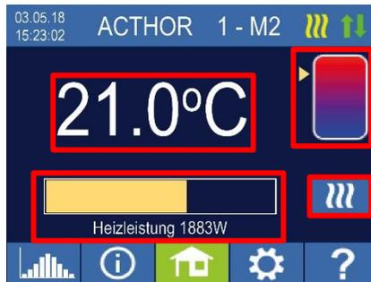
Pfeil zeigt welcher Heizstab gerade versorgt wird. (oben oder unten)
