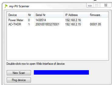
2. Befinden sich mehrere my-PV Geräte im Netzwerk, dann kann das zu konfigurierende Gerät anhand der Seriennummer (beim AC•THOR siehe Typenschild an der Rückseite des Geräts) bestimmt werden.
