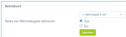
**Relais bei Wärmeabgabe aktivieren:** Ist diese Option „Ein“, so wird das Relais bei Wärmeabgabe für mindestens 120 Sekunden eingeschaltet. Das Relais kann so als potentialfreier Signalgeber verwendet werden.
